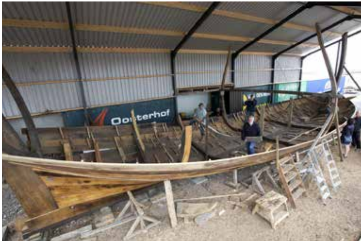
De onderschaal van de reconstructie was in 2013 gereed. Met tijdelijke, dwars over de huidnaden gespijkerde klampen werden de huidgangen bij elkaar gehouden. (Foto J. de Jager)
