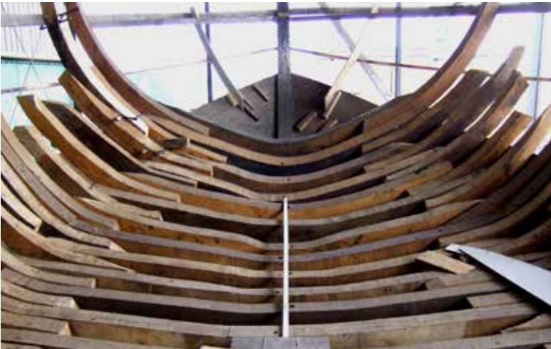
Het invullen van de bodemschaal met inhouten. Een consequentie van deze werkwijze is wel dat de afzonderlijke spantdelen niet onderling met elkaar verbonden kunnen worden. (Foto G. de Weerdt)
